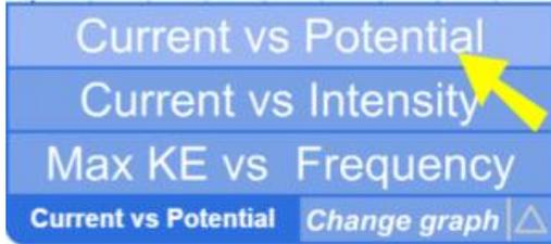
٩,١. التيار مقابل الكُمون (الفلطية): يرسم التغيرات في التيار الكهروضوئي كدالة للفلطية عبر الألواح. يحدث التخطيط عندما تقوم بتغيير الفلطية المُولدة من مصدر الطاقة.
