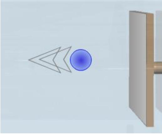
٥,٤. إذا كانت هذه الطاقة كافية لجعل الإلكترونات تصل إلى اللوحة الأخرى ويتم التقاطها بواسطة، فعندئذٍ يكون قد تأسس تيار كهربائي (يسمى التيار الكهروضوئي) بين الألواح.
